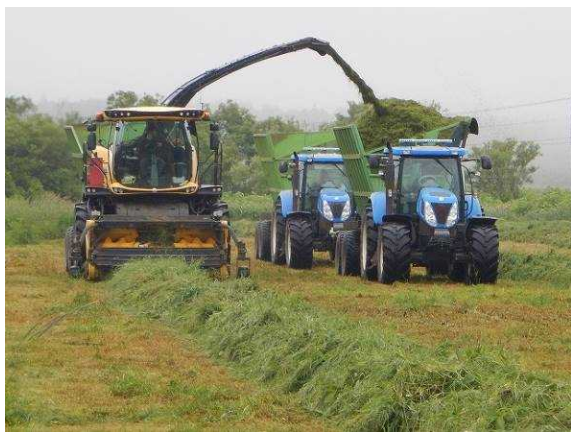
写真5 自走式フォレージハーベスタと テッピングワゴンの併走による収穫
