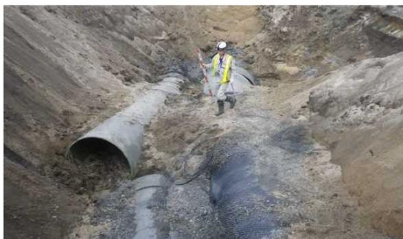
写真-1 パイプラインの地震被害の状況
