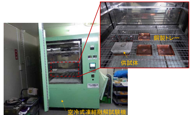
写真-3 空冷式の凍結融解試験機の全景と その内部の供試体及び銅製トレー
