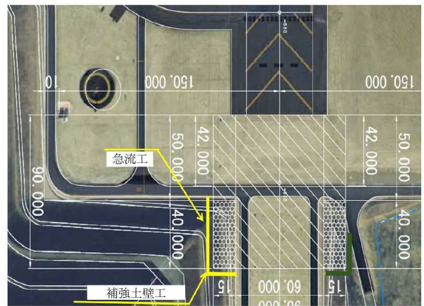
図-10 補強土壁工法の想定範囲
