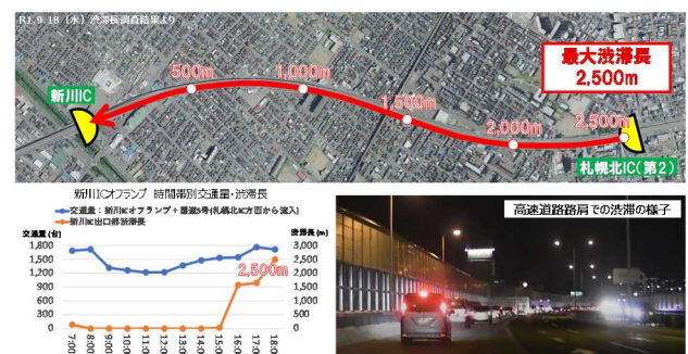
図-2 新川ICオフランプ 渋滞発生状況
