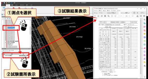
図-3 3次元設計データに管理情報を付与した品質管理の可視化
