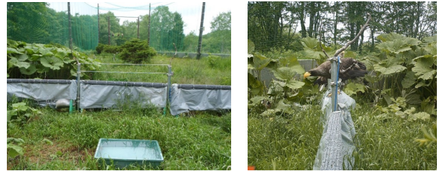
写真-13 ワイヤー実験施設(右:1本ではとまる様子)
