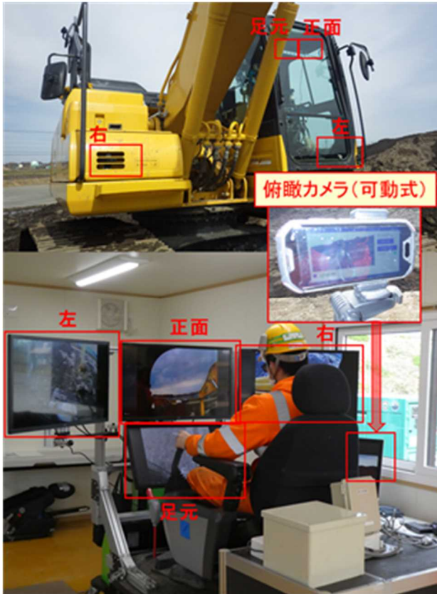
図-6 除雪車に設置したカメラ（上）の配置箇所とコックピット（下）への映像伝送イメージ
