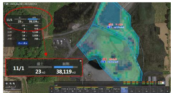
図-4 ドローンを用いた土量算出
