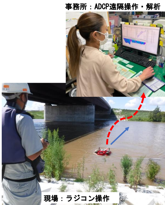
図-2 ラジコン式ADCPの観測状況
