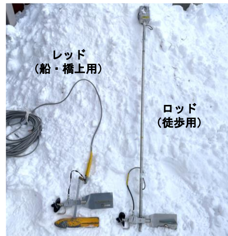
図-5 現行法の流速測定（ロッドとレッド）
