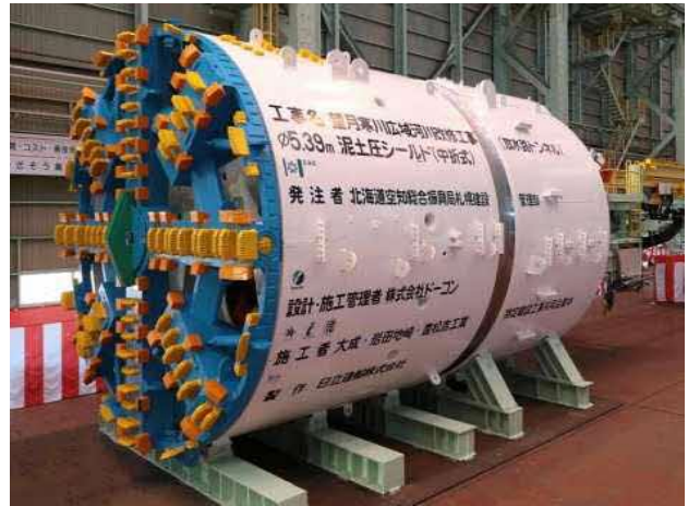
写真-5 シールドマシン
