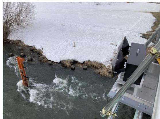
図-12 固定式電波流速水位計の計測点
