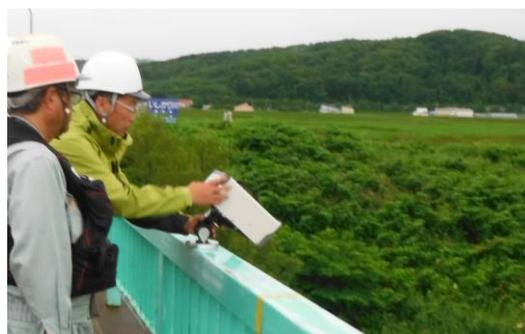
図-4 可搬式電波流速計による測定
