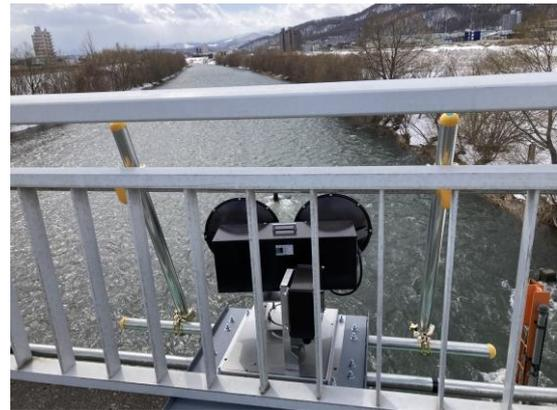
図-11 固定式電波流速水位計
