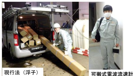
図-5 浮子と可搬式電波流速計の資材の比較
