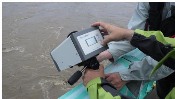
図-2 可搬式電波流速計
