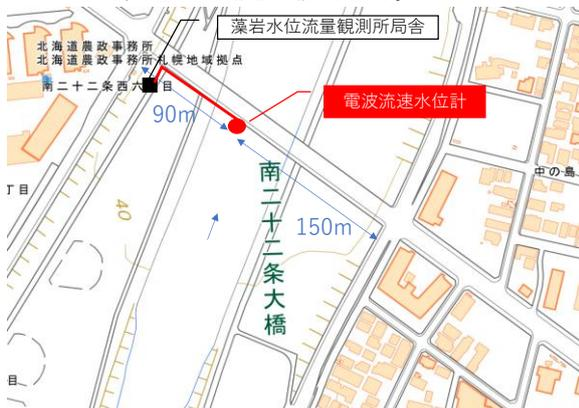
図-10 固定式電波流速水位計の設置位置
