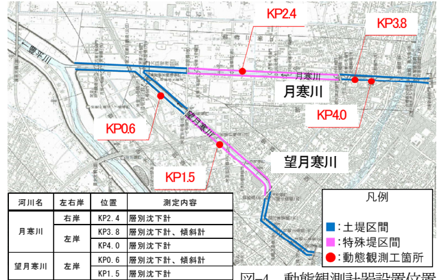
図-4 動態観測計器設置位置
