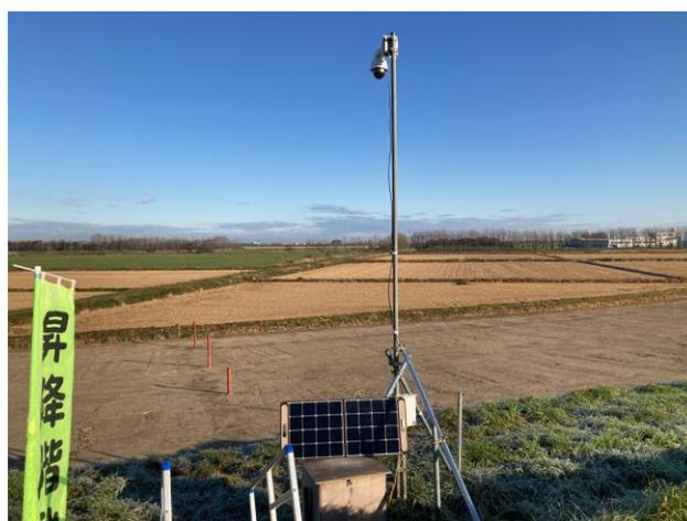
図-2 ソーラーシステムを用いた現場監視カメラ
