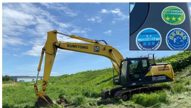
図-1 燃費基準達成型のバックホウ
