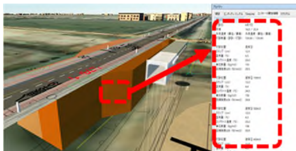
図-9 BIM/CIMモデルによる属性情報付与
