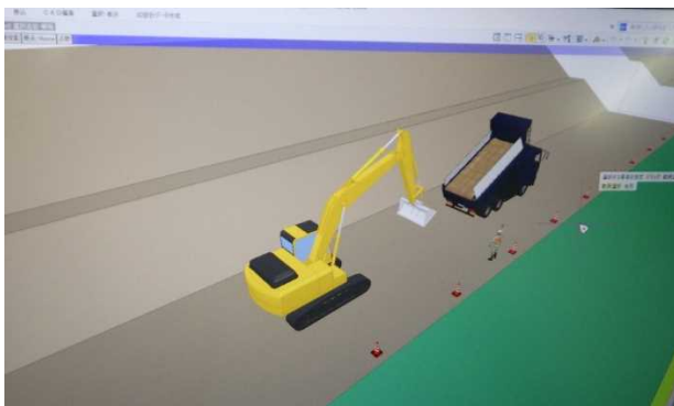
図-3 3次元データを元にした作業計画
