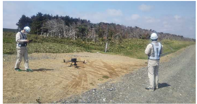
写真-5 UAVによる測量状況
