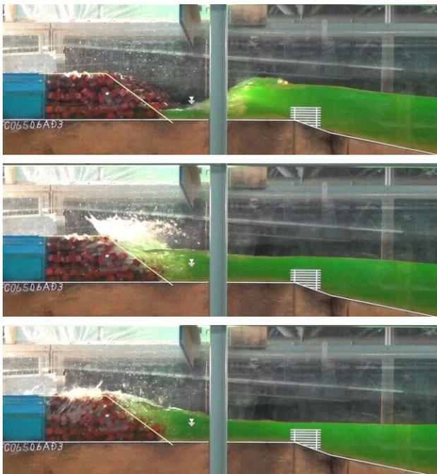
写真-7-2 消波工拡幅護岸の越波状況 ( $H_{1/3}=1.30\text{ m}$ )
