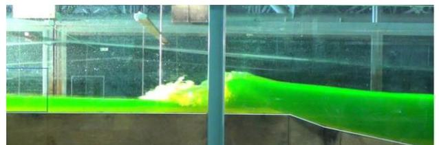
写真-5 水平床における巻波砕波直後 ( $t = 1,034$  s)
