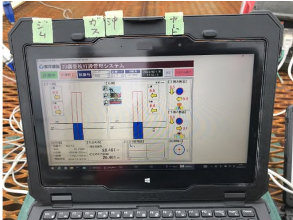
写真-2 打設杭トータル施工管理システム Pile T
