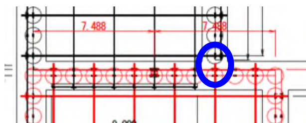
図-8 タイワイヤー干渉状況(構造図)
