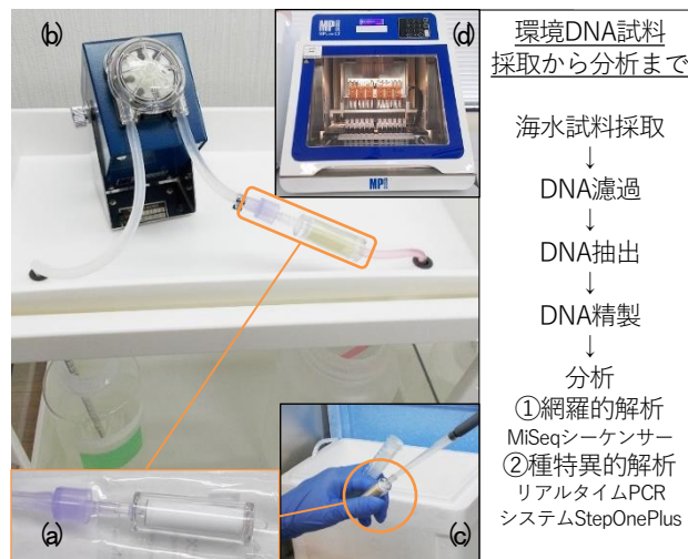
図-3 環境DNAの濾過、抽出、精製の手順 (a)ステリベクスフィルターユニット (b)ポンプによる環境DNAの濾過、捕集 (c)DNA抽出 (d)MPureによるDNA精製
