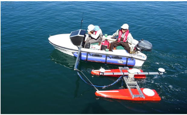
写真2 マルチビーム試験状況
