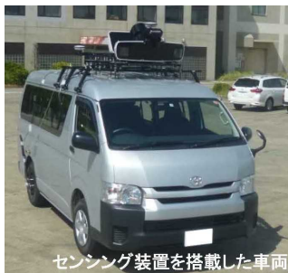
写真-3 MMS車両の外観
