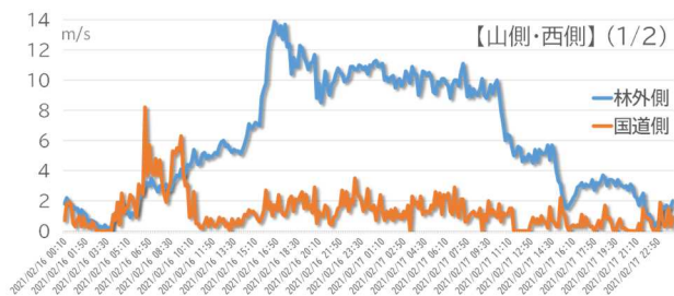
図-5 【山側・西側】山軽防雪林の林外側と、国道側での10分平均風速の変化：左図令和3年2月16日、右図2月28日
