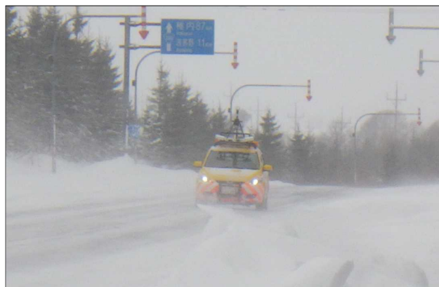
写真-9 視程障害移動観測車による山軽防雪林の計測状況
