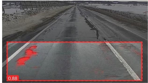
図-6 検証データを解析処理にかけて得られた結果の画像例
