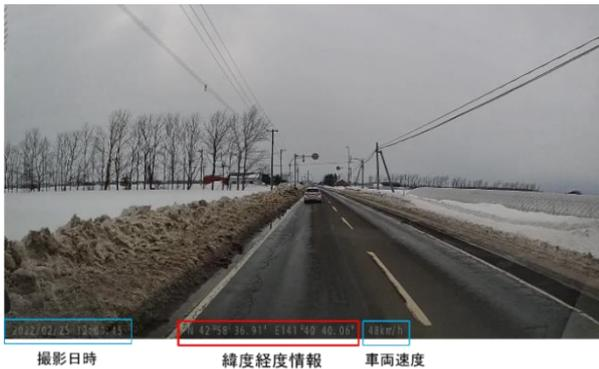
写真-1 ドライブレコーダーにて取得した解析対象画像の一例
