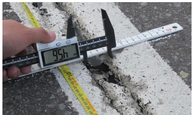
写真-4 縦継目の開き幅
