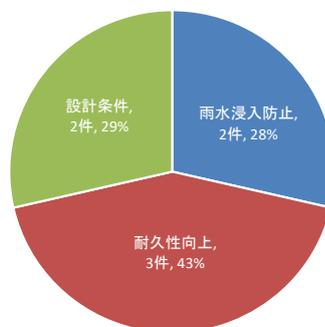
図-9 縦継目止水対策の目的
