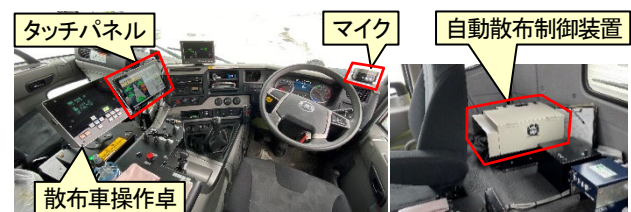
図-3 凍結防止剤散布車への凍結防止剤散布支援システムの搭載状況
