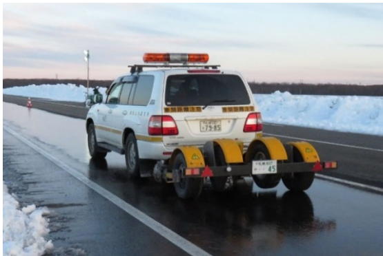
写真-5 連続路面すべり抵抗値計測装置
