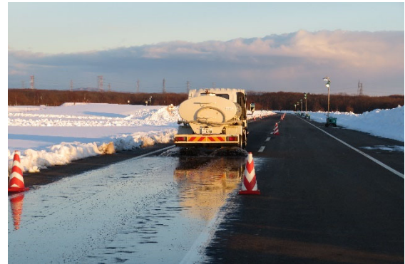
写真-2 氷膜路面作製
