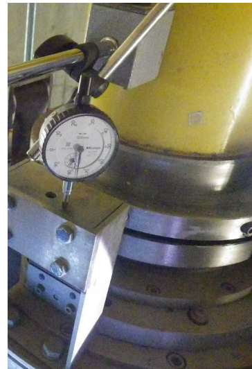
写真-9 インペラプロテクトライナー間のクリアランス計測状況 (インペラ降下量)
