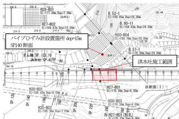
図-9 パイプひずみ計観測孔位置図 (新設)
