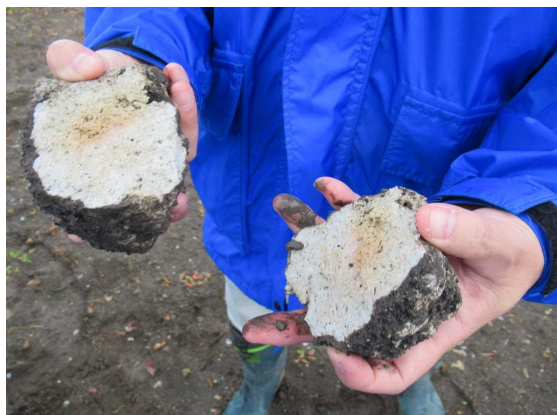
写真-5 手で破碎可能な噴石 (大平19工区)
