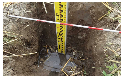
写真-6 観測孔による地下水位調査状況 (A圃場、2022年7月31日撮影)
