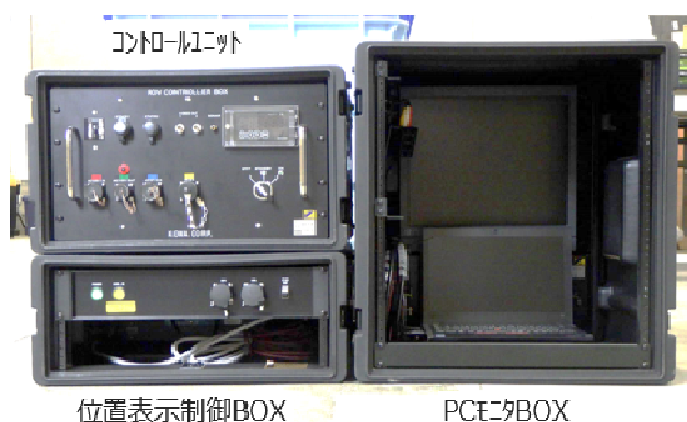
図-2 コントロールユニット、PCモニタBOX、位置表示制御BOX
