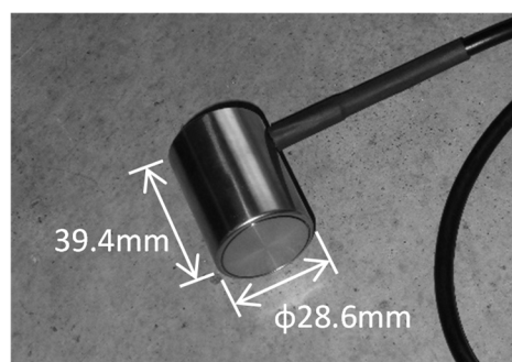
写真-1 AEセンサーの例 (MISTRAS社製 R3I-AST)
