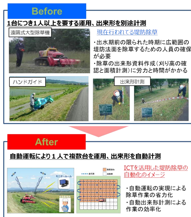
図-2 堤防除草の自動化イメージ
