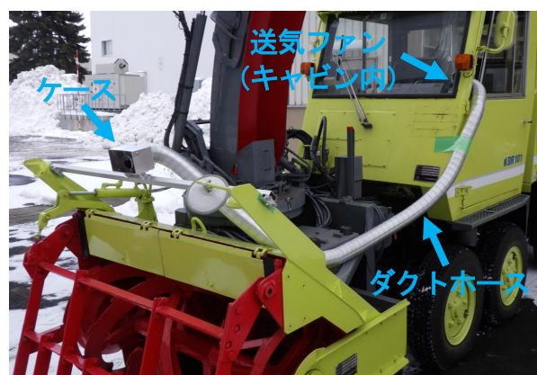
図-11 計測機器設置位置および雪付着対策
