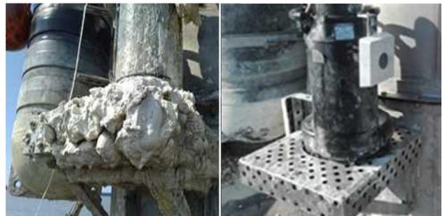
写真-2 吸水口の閉塞状況
