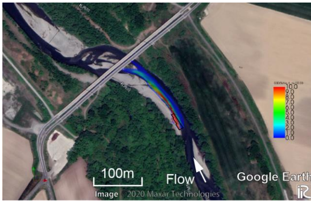
図-7 最大粒径に相当する 100mm の材料の輸送状況 (計算終了後)
