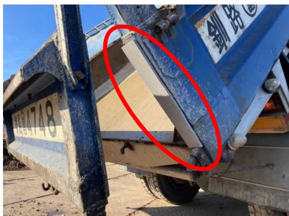
写真-8 荷台あおり部の緩衝材設置状況
