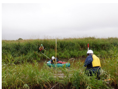
写真-2 沈砂池堆積土砂計測状況
