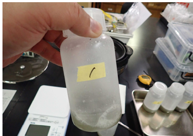
写真-4 フタ付きポリ瓶の攪拌・混合操作
