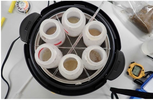
写真-5 電気グリル鍋を用いた加熱処理状況
