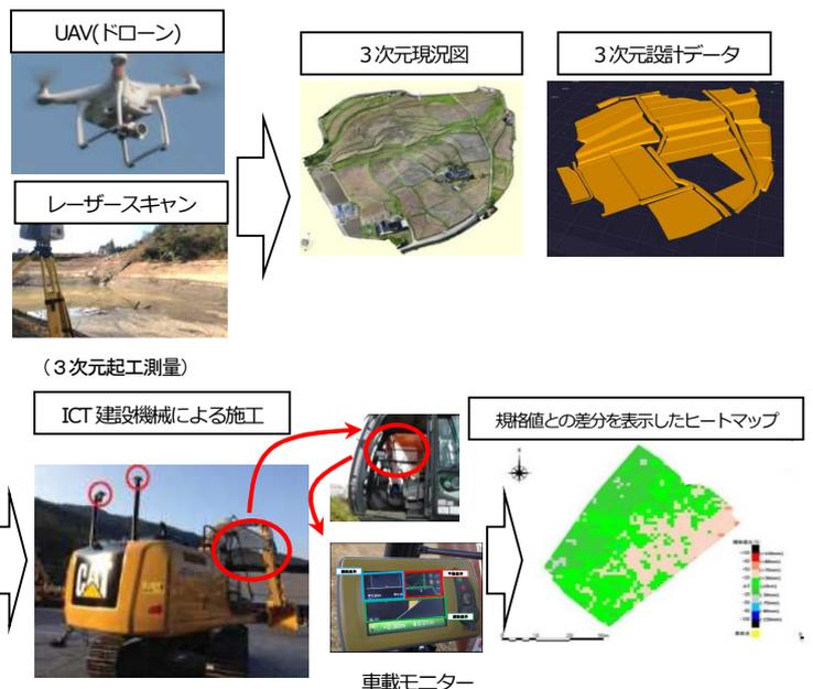
図-1 情報化施工活用工事の流れ<sup>1)</sup>
