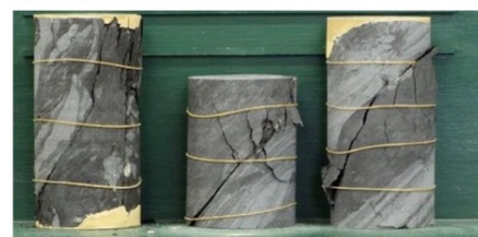
写真-1 B-5 区間における圧縮強度試験前後の供試体
