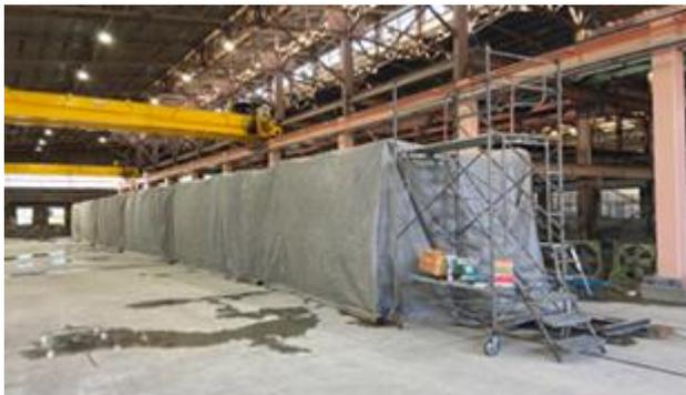
写真-1 蒸気養生（1次養生）状況
