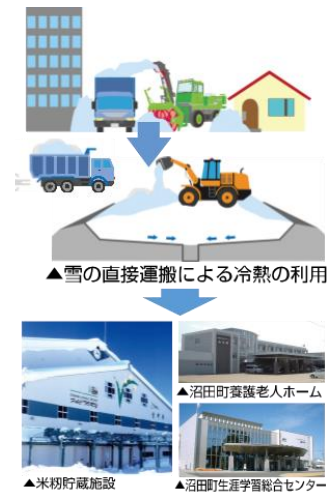
図-2 道路排雪の冷熱エネルギーとしての利活用
