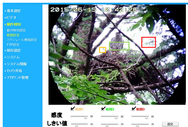
写真-3 ソフト内の動作検知箇所の設定（ここでは範囲1、2、3で動きがあった場合4秒間撮影）
