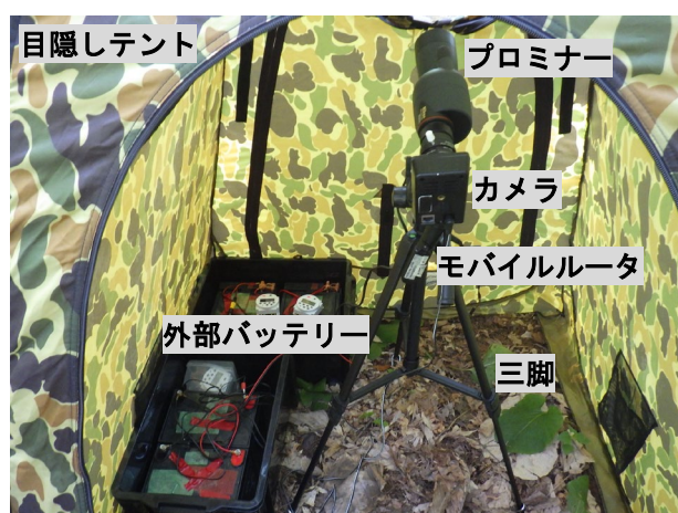
写真-2 本カメラシステムの設置状況
