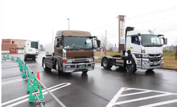
写真-4 縮小化したスペースでのヘッド交換の状況
