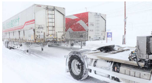
写真-5 冬期間のヘッド交換の状況
