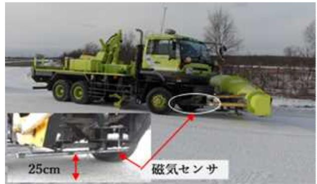
図-1 除雪トラック及び磁気センサ（MI センサ）設置状況
