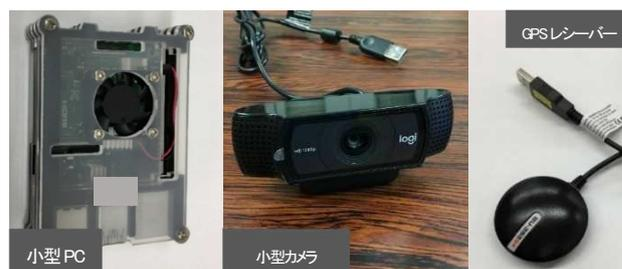
図-3 車載型カメラシステムの使用機材
