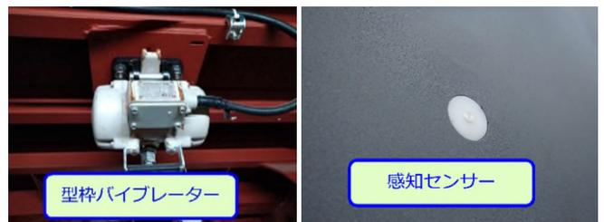
写真-3 型枠バイブレーター・感知センサー
