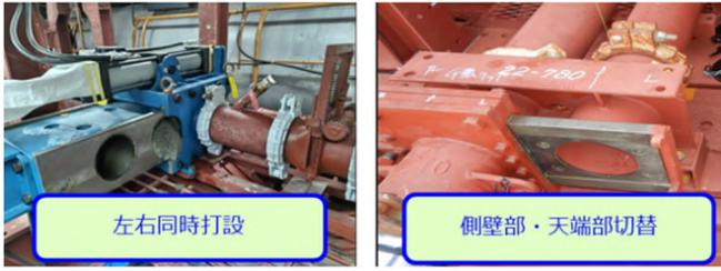
写真-4 電動式配管切替装置
