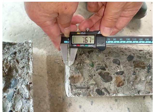
写真6 含浸深さ（吸水防止層）の確認
