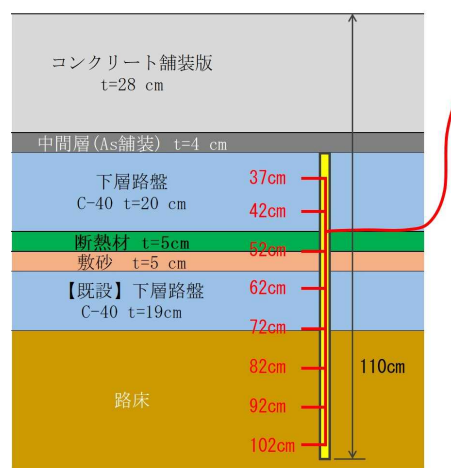
図-5 熱電対温度計設置深さ
