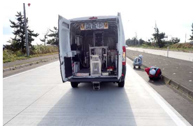
写真-3 FWD調査状況
